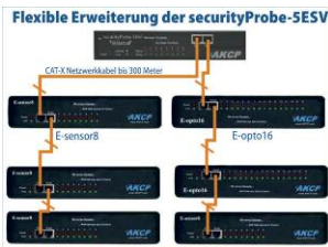
Abb.: Durch Montage von E-sensor8 oder E-opto16 Einheiten kann ein jedes aktuelle securityProbe-5ES/-5ESV Monitoring System bis zu 500 Sensoren überwachen.
