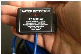
Abb.: Sehen Sie hier unseren Wassersensor für die zuverlässige Detektion von Wasser und Feuchtigkeit. Dieser Sensor sollte ebenfalls in missionskritischen Infrastrukturen vorhanden sein.
