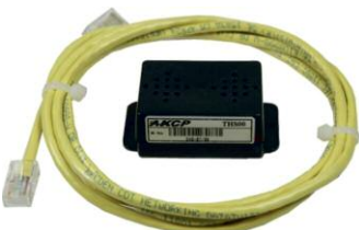
Abb.: Sehen Sie hier den kombinierten Sensor Temperatur und Luftfeuchte (Art.Nr. 10174). Dieser SNMP-kompatible Multi-Sensor wird nach ISO-Standard dauerhaft kalibriert. Auf Wunsch kann dieser Sensor mit Cat-5/6/7 Netzwerkkabel bis zu 300 Meter entfernt von den sensorProbe oder securityProbe Monitoring Systemen abgesetzt werden.
