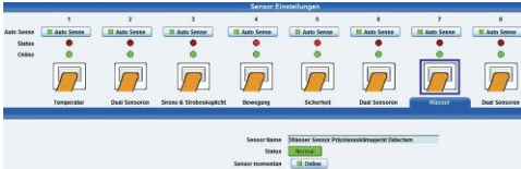
Abb.: Den Sensor Air Velocity Transmitter können Sie im Webinterface der sensorProbe oder securityProbe IP-Alarmserver individuell konfigurieren. Legen Sie fest, wie bei Abweichung oder Ausfall der Luftkühlung alarmiert werden soll (Screenshot securityProbe-5ES).
