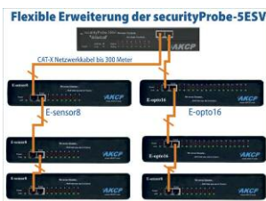
Abb.: Durch Montage von E-sensor8 oder E-opto16 Einheiten kann ein jedes aktuelle securityProbe-5ESV/-5ESV Monitoring System bis zu 500 Sensoren überwachen.
