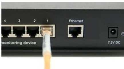
Abb.: Die Montage der zugehörigen Sensoren an das sensorProbe4 IT-Monitoring System ist einfach. Sie müssen nur den RJ-45 Stecker des Sensors in einen der 4 Sensor-Ports einstecken! Mit Unterstützung der AutoSense Funktion wird der angeschlossene Sensor automatisch erkannt und die Messung wird gestartet. Im Webinterface der sensorProbe4 können Sie dann den Sensor individuell konfigurieren.
