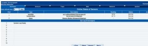
Abb.: Die SNMP-kompatiblen Sensoren können im Webinterface des sensorProbe4 Monitoring Systems individuell konfiguriert werden. Jeder Sensor besitzt ein SNMP OID, so dass die Abfrage auch per SNMP Befehl oder SNMP Polling folgen kann.
