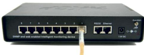
Abb.: Der Anschluss der IP-Sensoren an das sensorProbe8 Überwachungsgerät ist sehr einfach: Stecken Sie nur den RJ-45 Stecker des Sensors in einen der 8 Sensoranschlüsse! Per AutoSense Technik wird der Sensor dann automatisch erkannt und im Webinterface angezeigt. Hier können Sie dann den Sensor nach Ihren Wünschen individuell konfigurieren.
