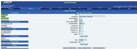
Abb.: Die angeschlossenen AKCess Pro Sensoren können im Webinterface des sensorProbe8 Monitoring Systems individuell konfiguriert werden. Jeder der Sensoren besitzt ein SNMP OID, so dass die Abfrage auch per SNMP Befehl oder SNMP Polling folgen kann.
