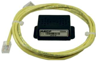
Abb.: Sehen Sie hier den präzisen DualSensor Temp. & Luftfeuchtigkeit (Art.Nr. 10174). Dieser Kombisensor wird nach ISO-Standard dauerhaft kalibriert und ermöglicht so eine präzise Temperatur und Luftfeuchtemessung. Per Cat5 Netzwerk-kabel kann dieser Sensor bis zu 300 Meter entfernt von der sensorProbe8-X60 abgesetzt werden.
