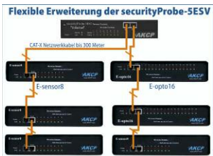
Abb.: Durch Montage von E-sensor8 oder E-opto16 Einheiten kann ein jedes aktuelle securityProbe-5ESV Monitoring System bis zu 500 Sensoren überwachen.
