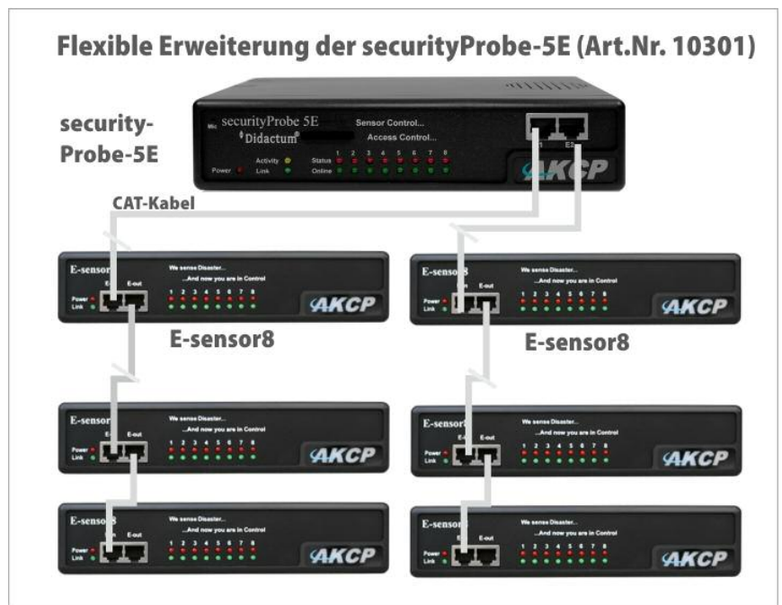
Abb.: Hier sehen Sie wie die E-sensor8 Erweiterungsmodul an einer securityprobe-5E in Reihe geschaltet werden können
