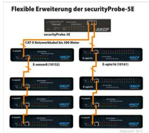
Abb.: Durch Montage von E-sensor8 oder E-opto16 Einheiten kann ein jedes aktuelle securityProbe-5E Monitoring System bis zu 500 Sensoren überwachen.
